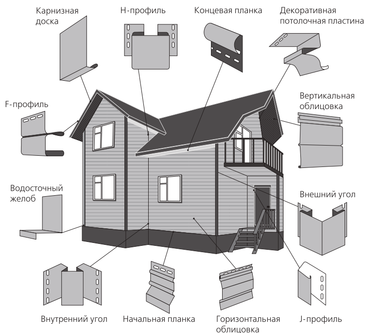
Рисунок 14. Типоразмерный ряд и места установки различных видов сайдинга
