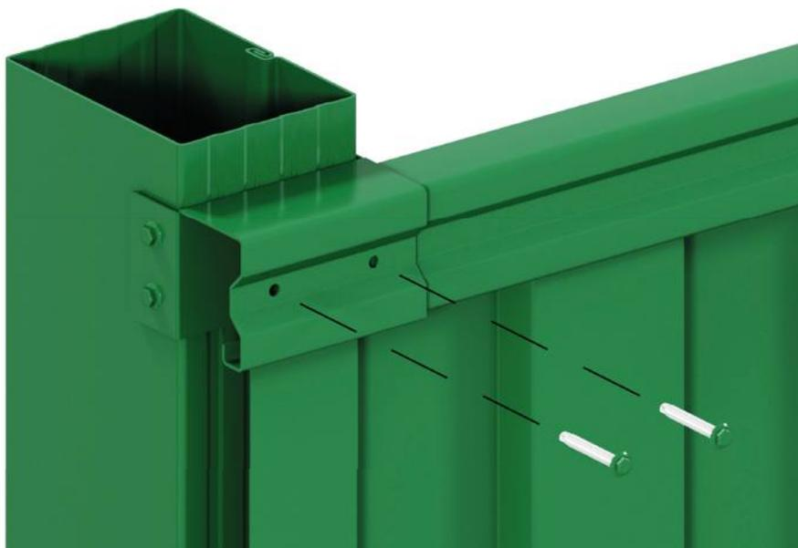
С внутренней стороны забора зафиксировать профнастил в верхнем и нижнем Т-профиле саморезами 5,5x19 мм с шагом 500 мм. Обязательно зафиксировать профнастил в местах взаимного нахлеста.
