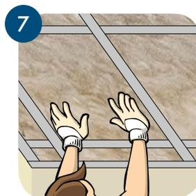
7 Устанавливаем АкустиKNAUF в каркас. Толщина материала определяется высотой конструкции.
