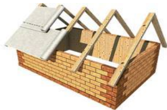
2. Укладка гидроизоляционной пленки
