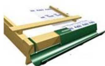
11. Монтаж водосточной системы
