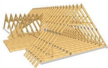
1. Монтаж стропильной системы
