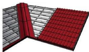
4. Монтаж ендов и примыканий
