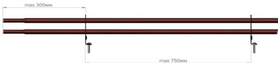
3. Для достижения нужной длины трубы снегозадержателя стыкуются между собой с помощью обжима с одной стороны. Стык фиксируется болтом и гайкой.
