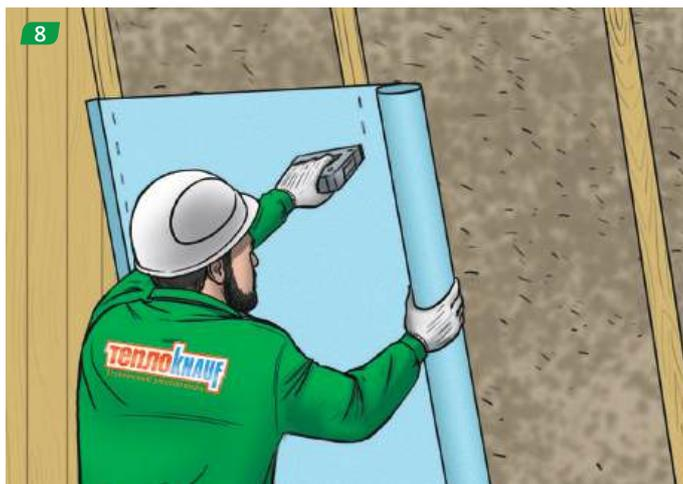
Раскатываем мембрану горизонтально вдоль нижней части стропил с заходом на стену и фиксируем степлером. Каждый последующий слой - выше предыдущего, нахлест в 10-15 см. Стыковка мембраны - только по стропилам. Стыковка мембраны в районе конька - внахлест.
