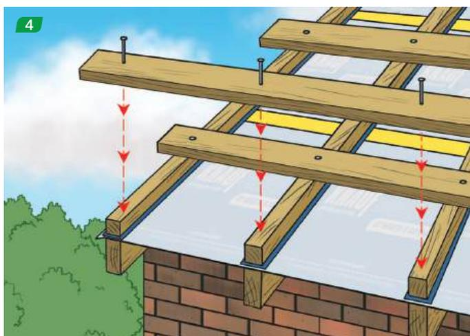
Поверх прижимного бруска устанавливаем горизонтальную обрешетку.
