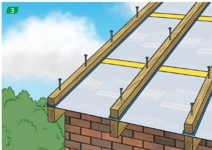
Проклеиваем мембрану вдоль стропил уплотнительной лентой. Устанавливаем сверху прижимной брусок и фиксируем его.
